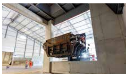
In de fabriekshal kiepen we de ROZA-slak onder een afzuiginstallatie die stof afvangt.
