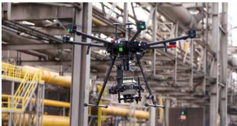
E-neus op een drone brengt geurprofielen in kaart van bronnen in omgeving Kooksfabriek 2.
